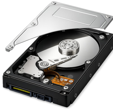
Figura 1.10: Un disco rigido da computer desktop, basato su piatti magnetici e componenti meccanici.
