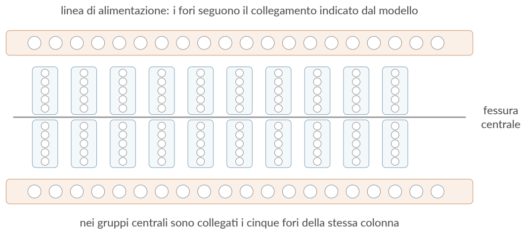
Figura A.6: Organizzazione tipica dei collegamenti interni di una breadboard. Prima dell'uso è opportuno verificare il modello disponibile in laboratorio.
