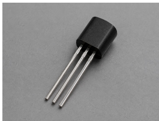
Figura 2.4: Esempio di transistor, componente elettronico utilizzato come elemento di commutazione nei circuiti digitali.
