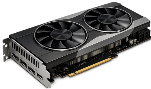
Figura 1.13: Una scheda video dedicata con GPU, memoria video, sistema di raffreddamento e connettore PCI Express.
